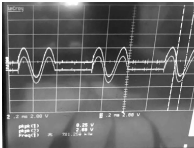
图 6 分时复用检测信号波形
