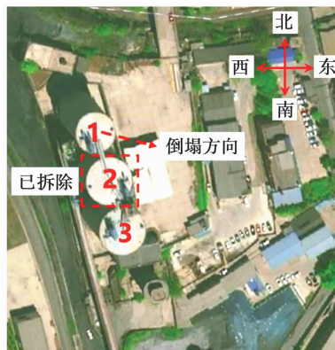
图5 1号混凝土筒仓预定倒塌方向
