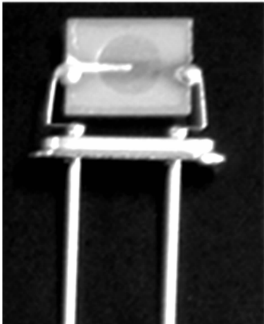
图 2 离子刻蚀工艺加工的晶体谐振器
