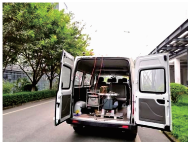
图 5 导航系统与标准惯导跑车试验照片
